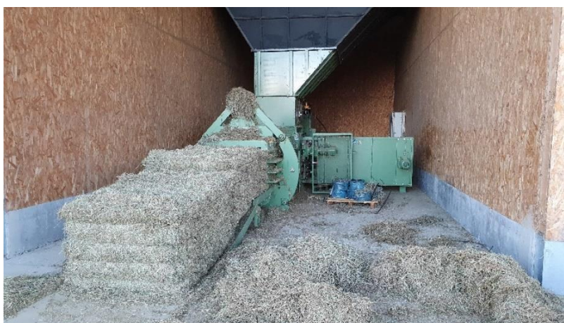
Figure 37 : Photo d'une presse industrielle en poste fixe en train de presser du dactyle (Source : AS DEV.)
