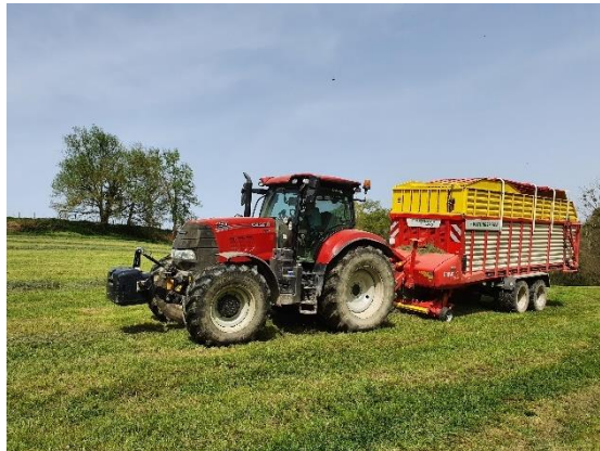
Figure 34 : Photo d'une remorque autochargeuse en cours de ramassage de foin vrac (Source : AS DEV.)
